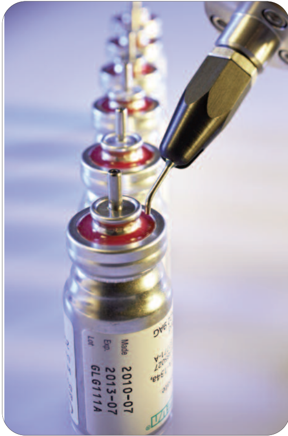
TS5440 – déposant une colle sur un appareil médical
