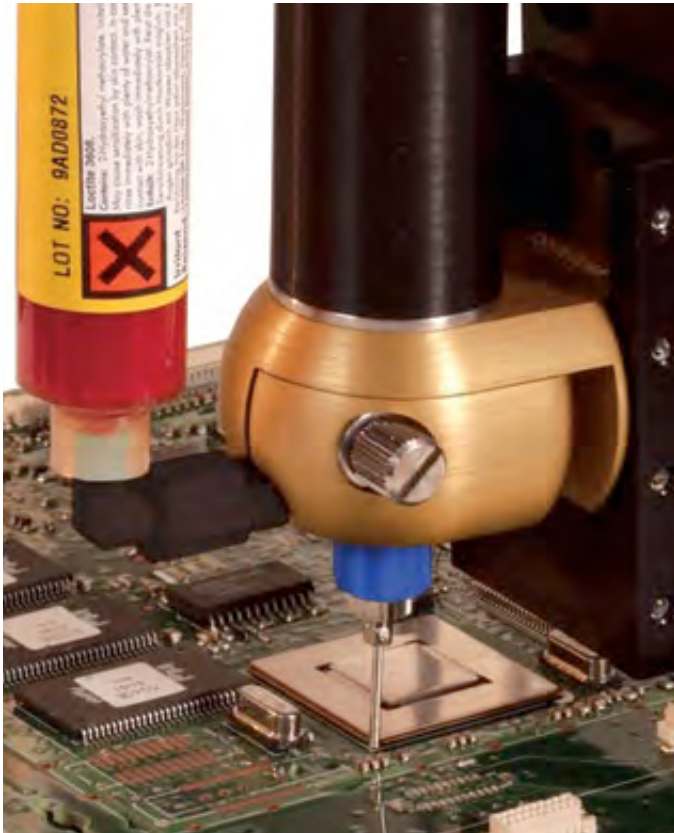
TS5000DMP - bei einer Underfill Anwendung
